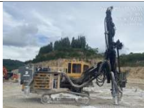
รูป AG การเจาะรูระเบิดจะต้องติดตั้งเครื่องมืออุดฝุ่นที่ บริเวณหัวเจาะ
